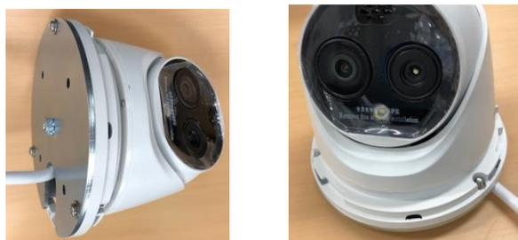
プレートを取付したら、三脚のネジ部分をプレートにねじ込んで取付ます。
