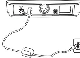
b. 受信機をミキサーまたはアンプに接続します。電源ボタンを押して受信機をオンにします。
