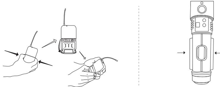
b. 送信機で、グループとチャンネルを設定して受信機に合わせます。受信機の音声LEDが点灯します。
