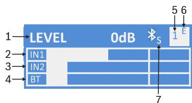
図 4.2: Bluetooth® ステータスを表示する、正常なシステム状態のホーム画面
