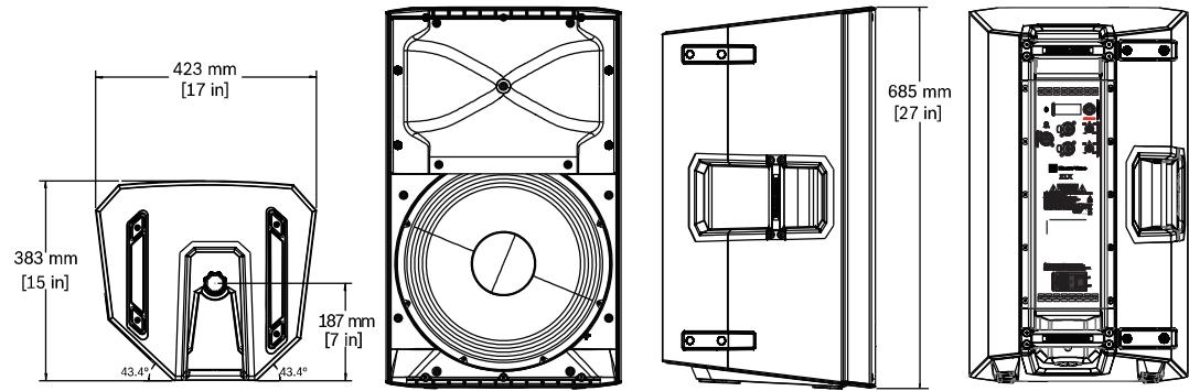
図 7.2: 寸法 : 15 インチ ZLX モデル
