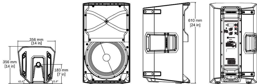
図 7.1: 寸法 : 12 インチ ZLX モデル
